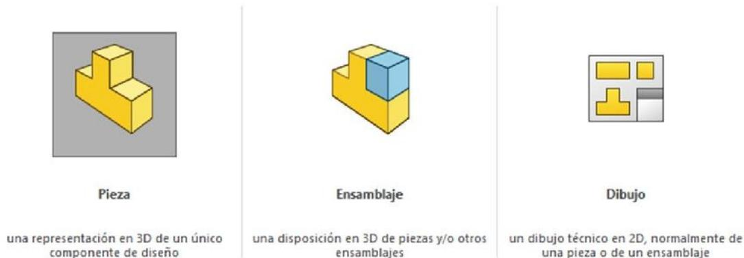
Figura 3.7: Módulos existentes en SolidWorks®
