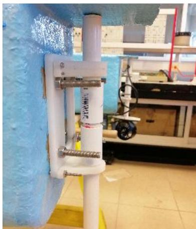
Figura 3.20: Montaje de los propulsores
