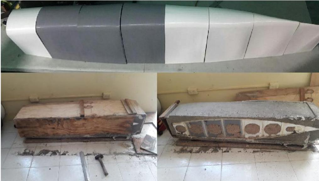
Figura 3.16: Molde de concreto
