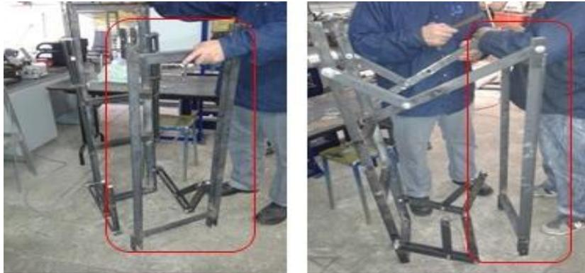
**Fig. 2. 6** Armado del mecanismo de elevación.
