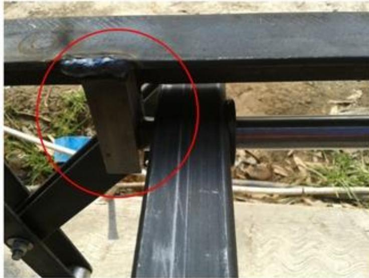
**Fig. 2. 9** Soporte de la corredera del mecanismo de elevación.
