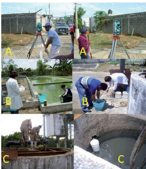
Figura 2. En el apartado A se muestra el levantamiento topográfico del terreno y levantamiento físico de las unidades de tratamiento, en el apartado B se presenta el muestreo de la planta de tratamiento, finalmente en el C se presenta el aforo en el cárcamo concentrador
