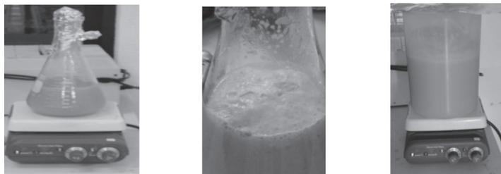
Figura 3. Producción y aclimatación de la cepa con néctar de mango y proceso de fermentación a un volumen de 4 L.
