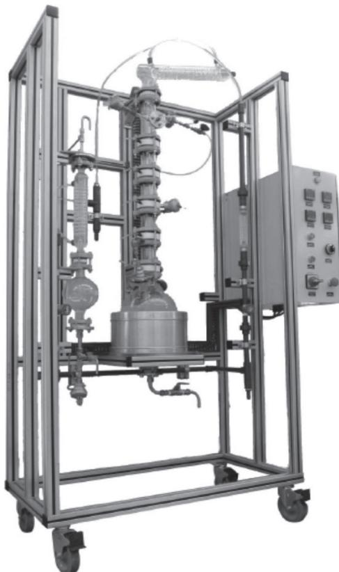
Fig. 1. Destilador en columna de platos a pequeña escala. PS-DA-005/PE
