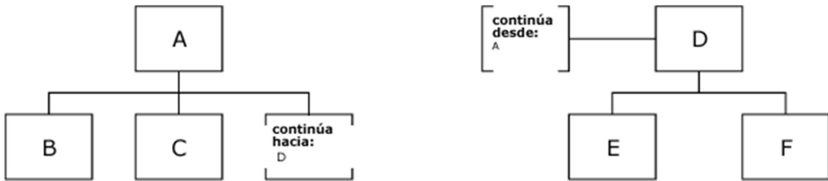
Figura 39a: [izquierda] Un punto "continúa hacia" referencia al lector hacia otro diagrama Figura 39b: [derecha] Un punto "continúa desde", retomando desde donde salimos.
